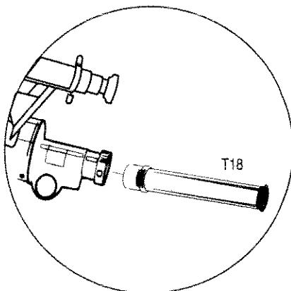
Lorsque l'on utilise l'oculaire T-18, on obtient un grossissement de 44X avec le télescope modèle 6330, et un grossissement de 50X avec le modèle 6440.
